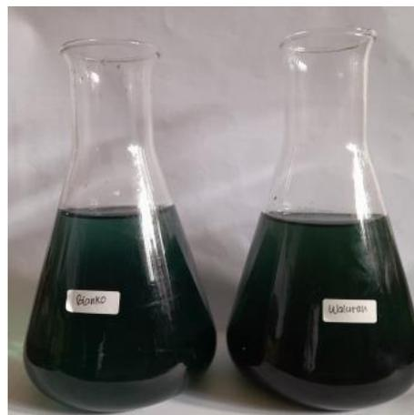
Gambar 3.9 Hasil titrasi uji MOT
