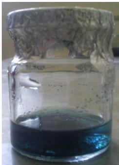
0,7 g; 0,9 g; 1,1 g biomassa kering mikroalga campuran dan tanpa biomassa sebagai kontrol (gambar 3.2). Masing-masing botol kemudian dikocok dengan menggunakan inkubator berputar pada kecepatan 200 rpm selama 30 menit (Inthorn *et al.*, 2002:254). Setelah itu, biomassa siap dianalisis.
