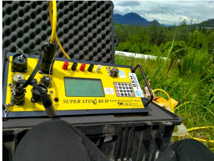
Gambar 3.8 Proses pengambilan data geolistrik resistivitas
