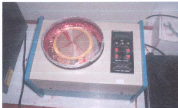
Gambar 3.5. Pemberian resis dengan Spin Coater Model P6000
