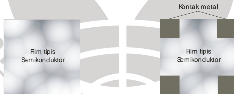
Gambar 3.3. Pemasangan kontak metal pada film tipis GaN
