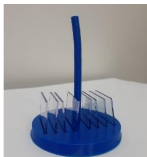
Gambar 3.3 Alat dan Bahan pembersihan kaca ITO
