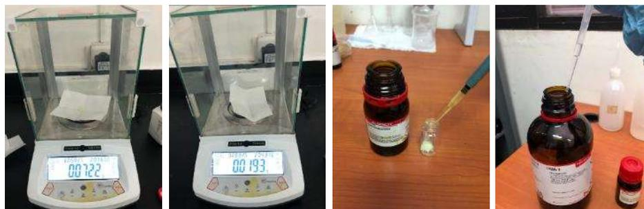
Gambar 3.9 Proses Pembuatan Spiro-OMeTAD
