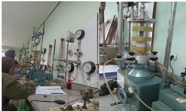
Gambar 3. 11 Dokumentasi pengujian sifat keteknikan tanah – Uji Triaxial
