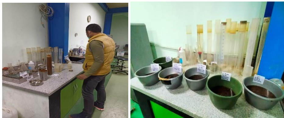
Gambar 3. 10 Dokumentasi pengujian Analisis Besar butir dan Hidrometer
