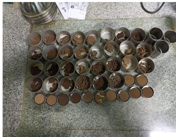
Gambar 3. 8 Dokumentasi pengujian Batas-Batas Atterberg
