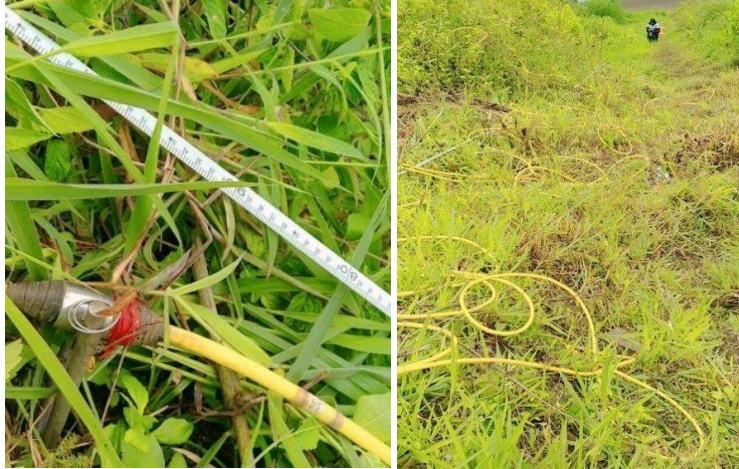
Gambar 3. 4 Penanaman Elektroda Pada Lintasan Gunung Batu
