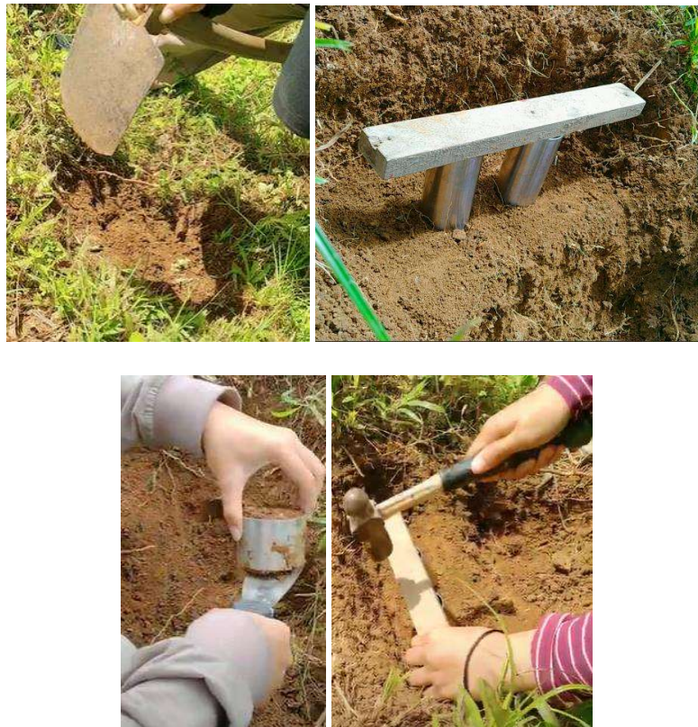
Gambar 3. 6 Pengambilan Sampel Tanah Pada Gunung Batu
