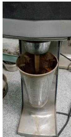
Gambar 3. 19 Alat *mechanical stirrer* untuk mengaduk sampel tanah dengan larutan dispersi.
