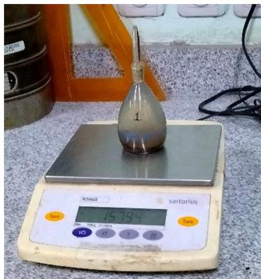
Gambar 3. 13 Ketika menimbang tabung piknometer yang berisi sampel tanah yang telah diberi air suling.
