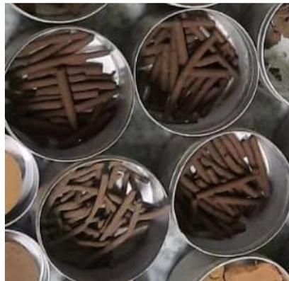
Gambar 3. 15 Sampel tanah dalam pengukuran batas plastis yang sudah dikeringkan
