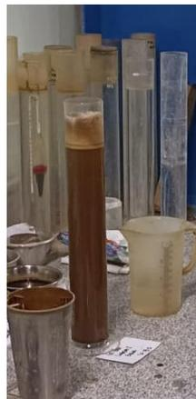
Gambar 3. 20 Larutan yang akan diukur pada waktu tertentu, untuk mengetahui suhu dan hidrometer untuk mengetahui ukuran butir tanah tersebut.
