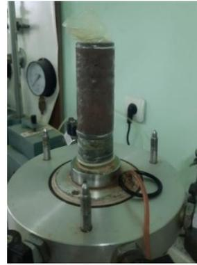
Gambar 3. 21 Sampel tanah yang sudah dilapisi membran dan terpasang pada alat.
