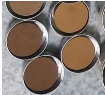
Gambar 3. 16 Sampel tanah dalam pengujian batas susut yang sudah dikeringkan.
