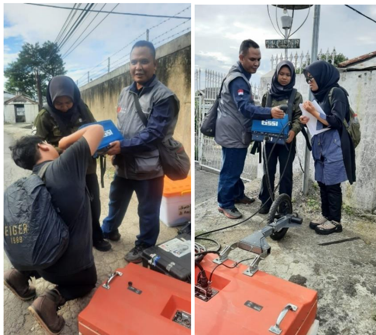
Gambar 3. 6 Penyetelan alat GPR
