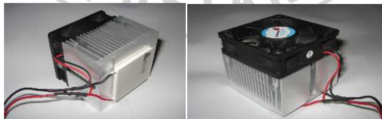
Gambar 3.9. Pemasangan Peltier, Heatsink, Fan Menggunakan Baud
