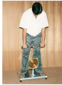
Gambar 3.4 Tes Back Dynamometer (Sumber: www.google.com )
