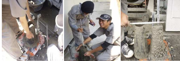
Gambar 3.14 Proses pelaksanaan uji slump
