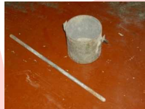
Gambar 3.6 Tongkat pemadat dan wadah baja
