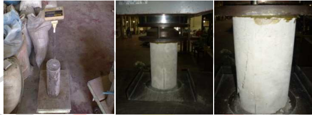
Gambar 3.19 Proses uji kuat tekan beton
