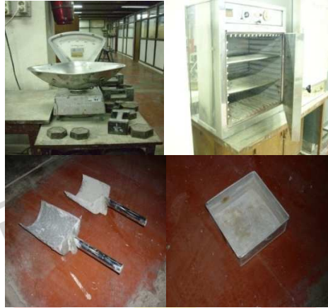
Gambar 3.3 Timbangan, oven, sekop dan talam
