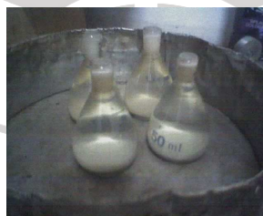
Gambar 3.6 Piknometer Alat untuk pengujian Specific Gravity
