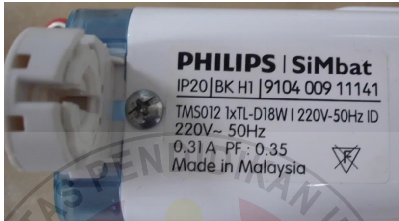
Gambar 3.2 Spesifikasi Lampu TL
