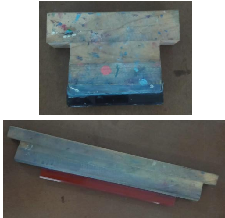
Gambar 3. 14 Studi Karet Rakel Keras Dan Lunak (Sumber: Dokumentasi Penulis, 2022)
