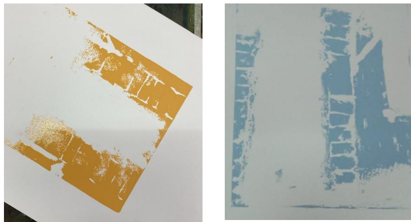
Gambar 3. 12 Studi Screen T120 Dengan Tinta Offset Peony (Sumber: Dokumentasi Penulis, 2022)
