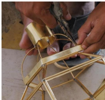
Gambar 3. 29 Proses Patri Kerangka (Sumber : Dokumentasi Penulis, 2022)
