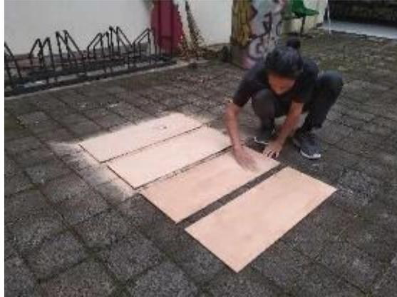
Gambar 3. 44 Proses pengamplasan MDF setelah proses pendempulan
