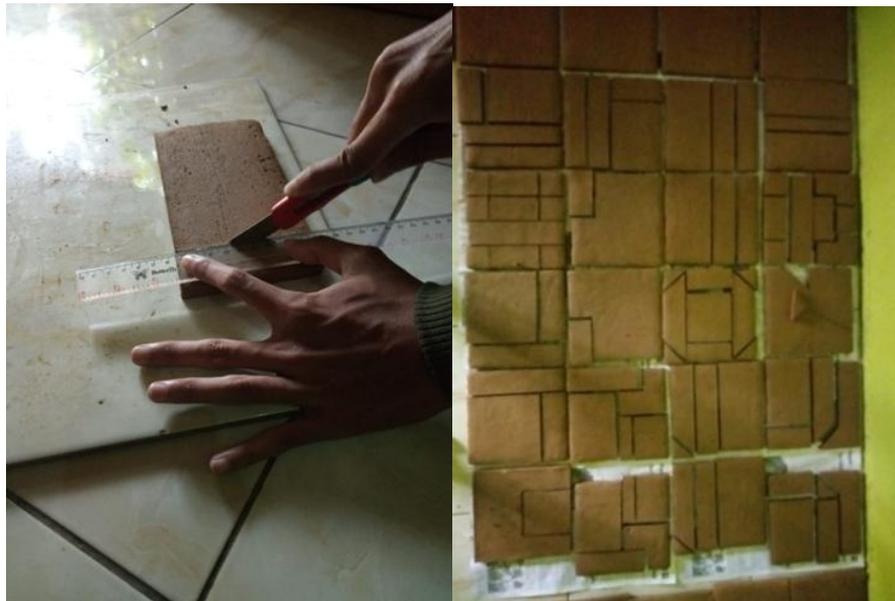
Gambar 3.29. Proses pembentukan/pemotongan tanah.
