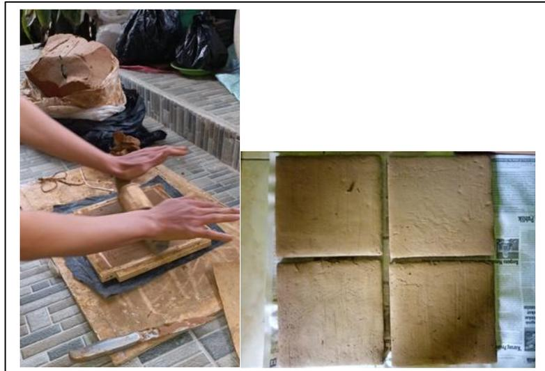
Gambar 3.28. Proses pencetakan tanah.
