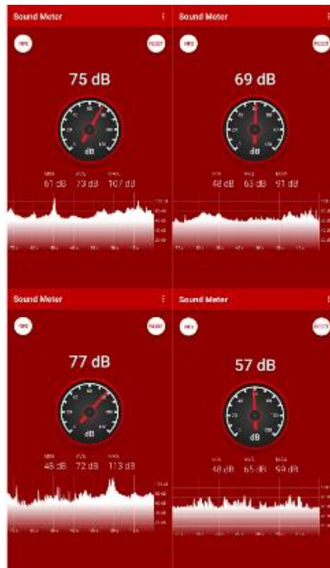
Gambar 16. Pengukuran Kebisingan dengan Aplikasi Sound Meter . Sumber Gambar : Sound Meter
