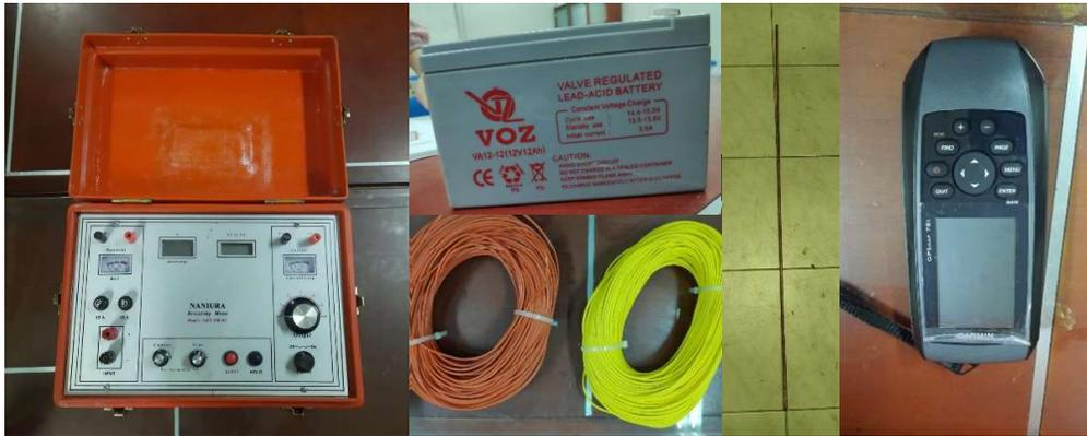
Gambar 3.4 Alat Geolistrik (Resistivity Meter, Aki, Kabel, Elektroda, dan GPS)
