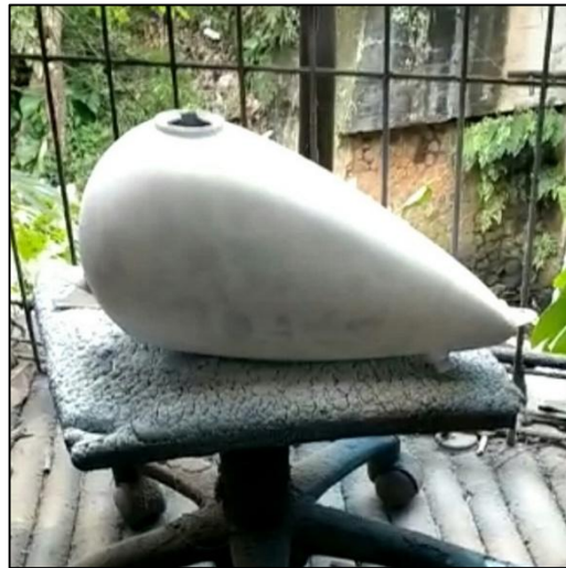
Gambar 3. 25 Tahap Pengecatan Warna Dasar
