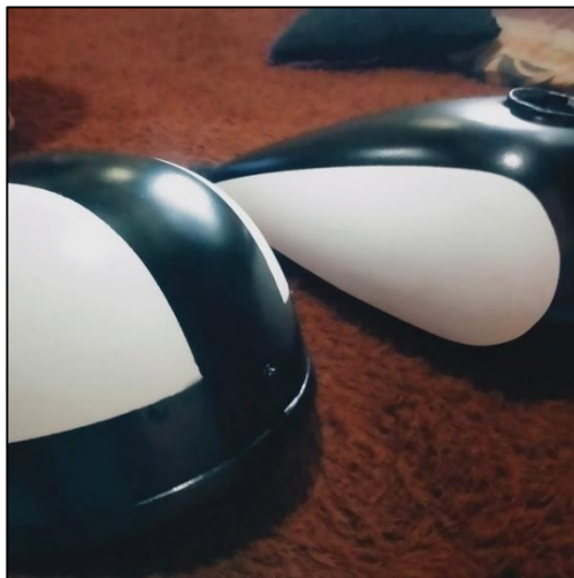
Gambar 3. 27 Tahap Pengecatan Warna Dasar
