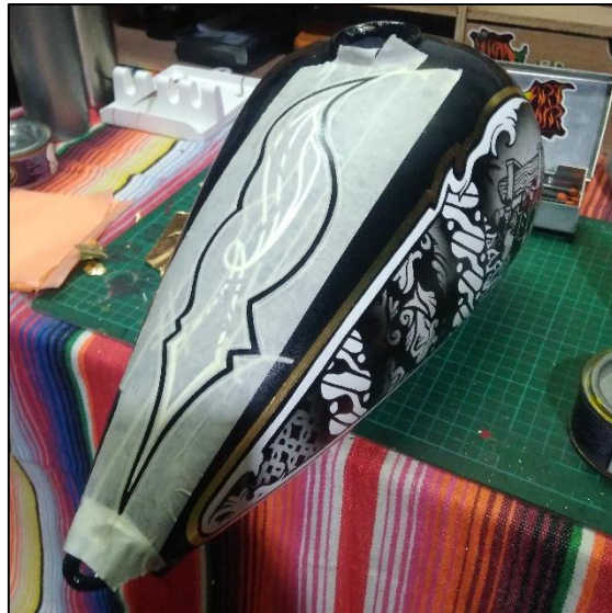
Gambar 3. 43 Tahap Pemasangan Gold Leaf
