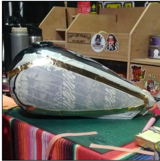
Gambar 3. 42 Tahap Pemasangan Gold Leaf
