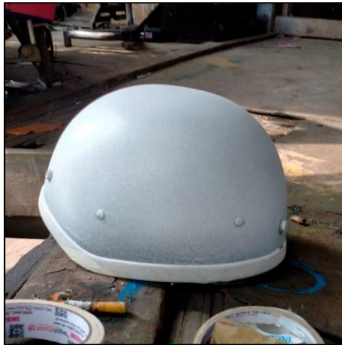
Gambar 3. 26 Tahap Pengecatan Warna Dasar
