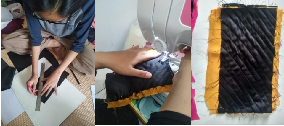
Gambar 3. 11 Proses Pembuatan Fabric Slashing Sumber: Dokumentasi Pribadi, 2022)
