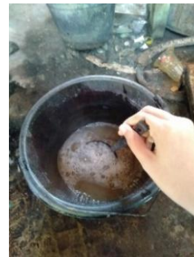
Gambar 3. 54 Proses Pelarutan Zat Pewarna Naphthol Pertama Sumber : Dokumentasi Pribadi (2022)
