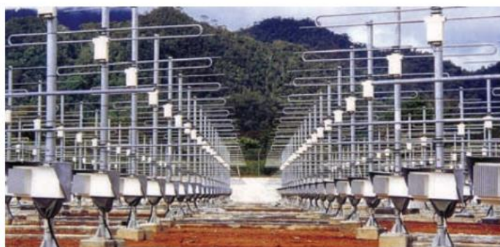
Gambar 3. 5 Antena Yagi 3-elemen dengan masing-masing terpasang modul penerima-transmisi (TR modules) dekat dengan ground di kutub. Sumber: (Fukao dkk., 2003)
