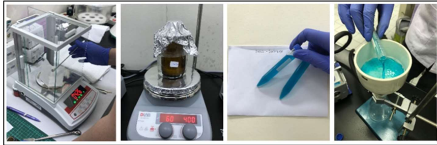
Gambar 3.6 Prosedur sintesis CZTS: (dari kiri ke kanan) Penimbangan bahan, pengadukan prekursor, hasil sentrifugasi, penyaringan prekursor CZTS
