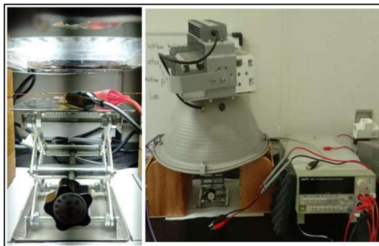
Gambar 3.11 Pengukuran sel surya CZTS di bawah solar simulator
