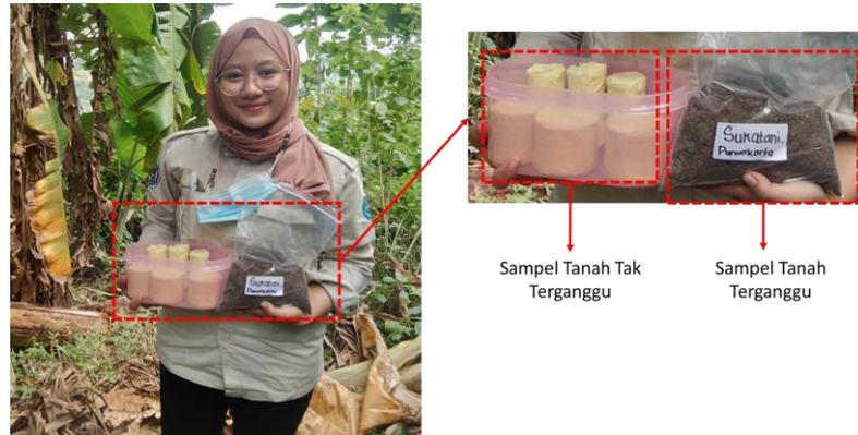
**Gambar 3. 7.** Contoh sampel tanah tak terganggu (memakai tabung tanah) dan tanah terganggu (memakai *zipper bag*).
