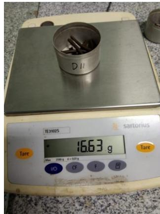
**Gambar 3. 13.** Contoh sampel setelah dimasukkan kedalam oven selama 24 jam pada pengujian batas plastis.
