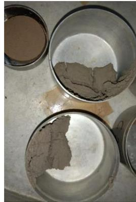
**Gambar 3. 12.** Dua buah sampel setelah dimasukkan kedalam oven selama 24 jam pada pengujian batas cair.
