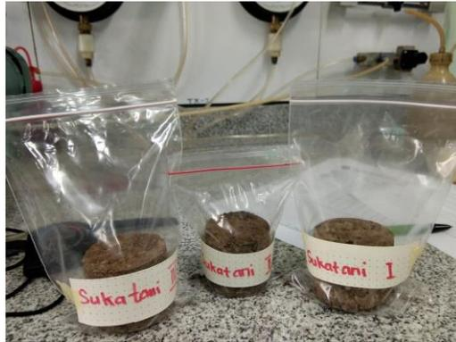
**Gambar 3. 11.** Contoh tanah kering yang sudah dikeluarkan dari tabung/*ring* tanah.
