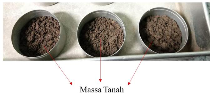
**Gambar 3. 9.** Tiga buah sampel dengan massa yang berbeda untuk pengukuran kadar air
