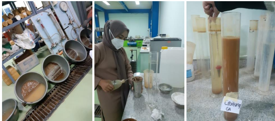
Gambar 3.17 Gambaran umum mengenai prosedur analisis hidrometer
