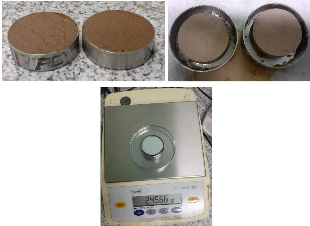
Gambar 3.15 Pengujian Batas Susut
