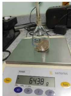
Gambar 3.12 Contoh pengukuran piknometer yang berisi massa tanah yang telah dihaluskan
