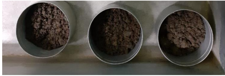
Gambar 3.8 Tiga buah sampel dengan massa yang berbeda untuk pengukuran kadar air
