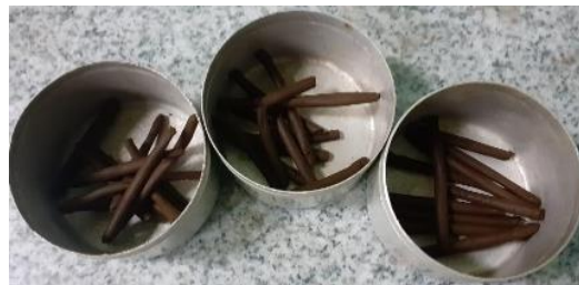
Gambar 3.14 Pengujian Batas Plastisitas
