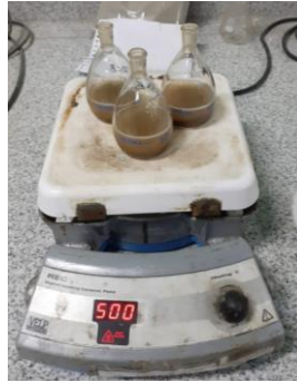
Gambar 3.10 Proses mengeluarkan udara yang terdapat dalam tanah dengan cara memanaskan piknometer
