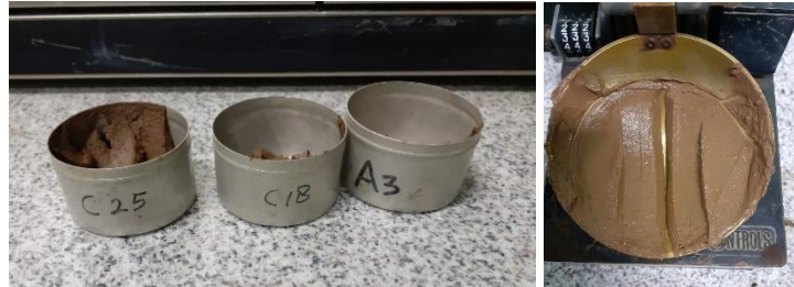
Gambar 3.13 Pengujian Batas Cair
