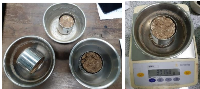
Gambar 3.9 Pengujian Berat Isi Tanah
