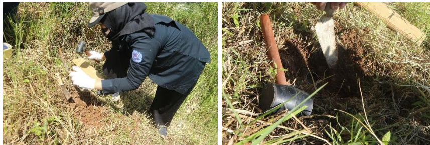
Gambar 3.7 Pengambilan Sampel Tanah
