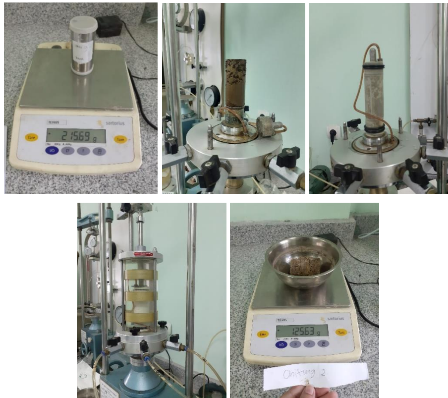
Gambar 3.18 Uji Triaxial CU - BP
