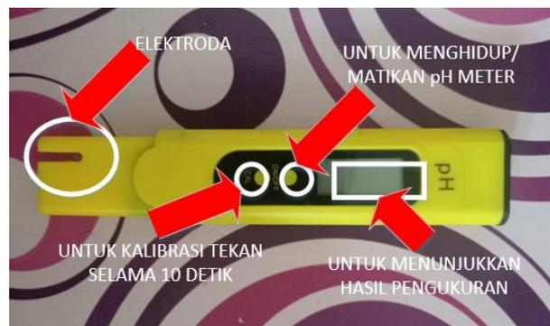
Gambar 3. 21 Prosedur pengukuran pH
