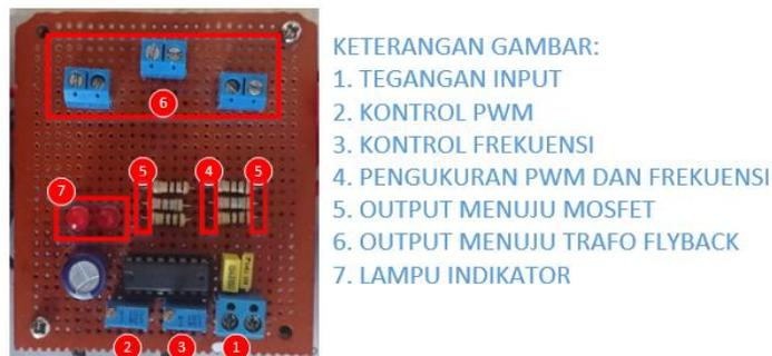
Gambar 3. 5 Blok komponen osilator PWM
