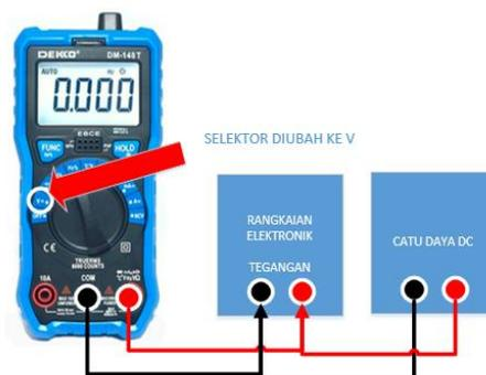
Gambar 3. 17 Prosedur pengukuran tegangan *input*
