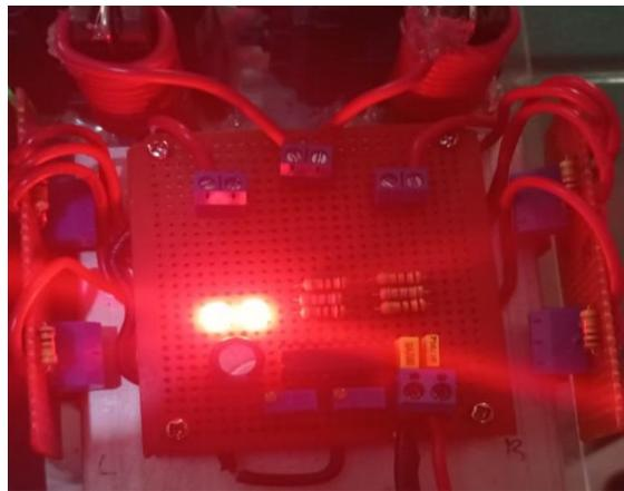
Gambar 3. 9 Rangkaian osilator PWM menggunakan IC TL494
