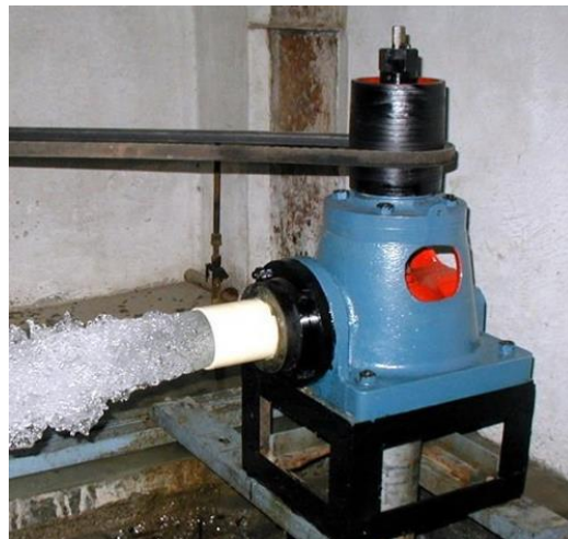
Gambar 2.6 Pompa Centrifugal dikopel dengan elektromotor
