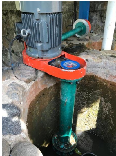
Gambar 3 4 Turbin yang di gunakan Oleh PLTPH Cihanjuang Cimahi
