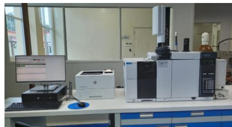
Gambar 3.12. Perangkat GC-MS (*Komunikasi Pribadi, 2021)
