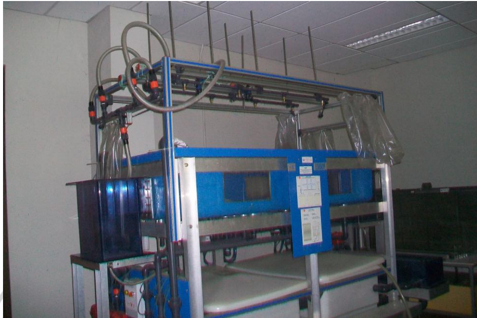
Gambar 3.2 Alat rainfall simulator di laboratorium hidrologi dan hidrolika Jurusan Pendidikan Teknik Sipil Universitas Pendidikan Indonesia Sumber: Lab. Hidrologi dan Hidrolika
