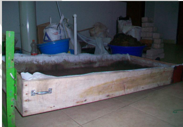
Gambar 3.4 Kotak Pengetesan Dengan Kemiringan Yang Dapat Disesuaikan
