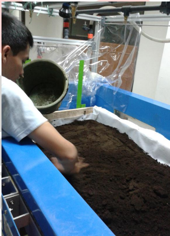
Gambar 3.7 Memasukan Tanah Kedalam Kotak Pengetesan
