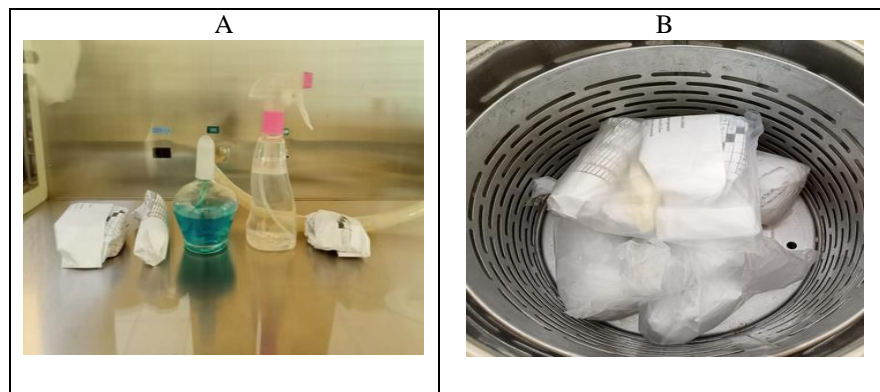
Gambar 3.3 Sterilisasi Alat. A. Alat yang digunakan untuk penanaman di dalam LAF B. Sterilisasi alat di dalam autoklaf dengan suhu 120°C dan tekanan 1,5 atm selama 30 menit.
