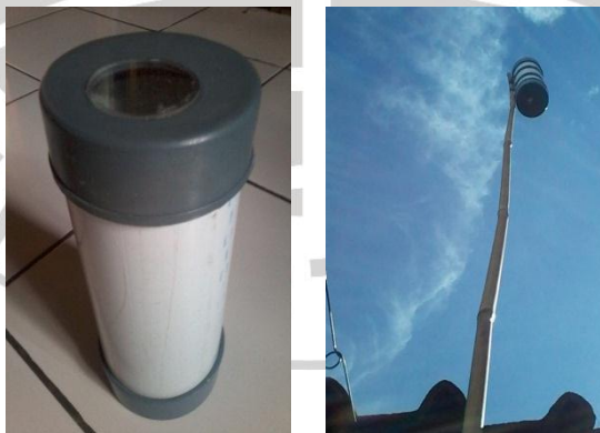
Gambar 3.2. Tabung SQM untuk pengukuran di luar (kiri) dan Pemasangan SQM pada Tiang (kanan). Lokasi pengamatan di Sadang Serang
