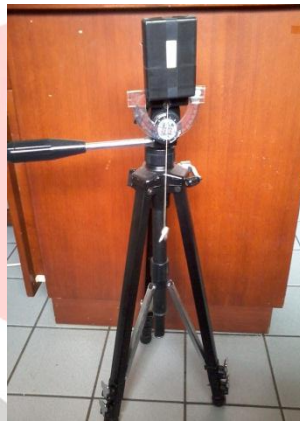
Gambar 3.1. SQM-LU Terpasang pada Tripod. Busur dan bandul digunakan untuk mengarahkan SQM-LU secara presisi
