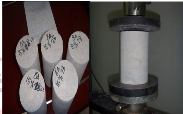
Gambar 3.7. pengujian kuat tekan beton
