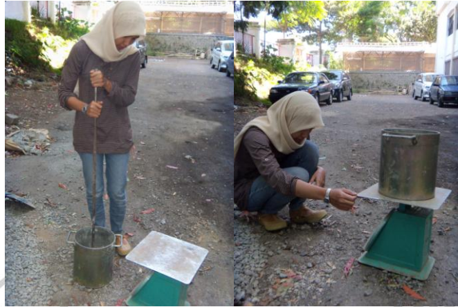
Gambar 3.1. pengujian berat volume agregat
