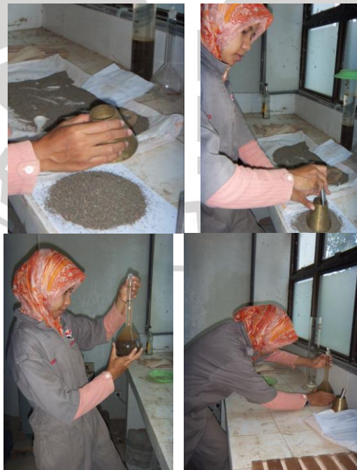
Gambar 3.4. pengujian analisis spesifik gravitasi dan penyerapan agregat halus
