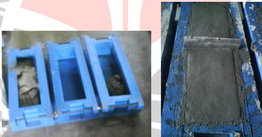
**Gambar 3.6** Proses Pencetakan Benda Uji
