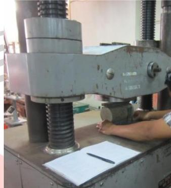
**Gambar 3.13** Proses Meletakkan Benda Uji Pada Mesin Tekan
