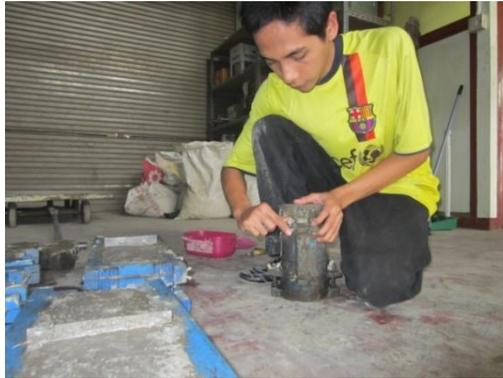
**Gambar 3.7** Proses Pembongkaran Cetakan
