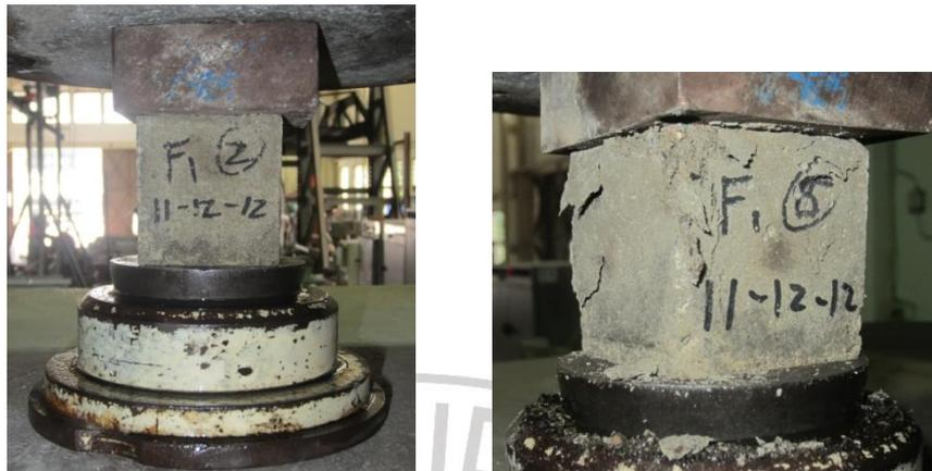
Gambar 3.10 Pengujian Tekan Mortar
