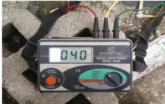
Gambar 3.18 hasil pengukuran di titik E
