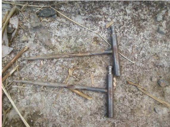
Gambar 3.4 dua batang elektroda bantu
