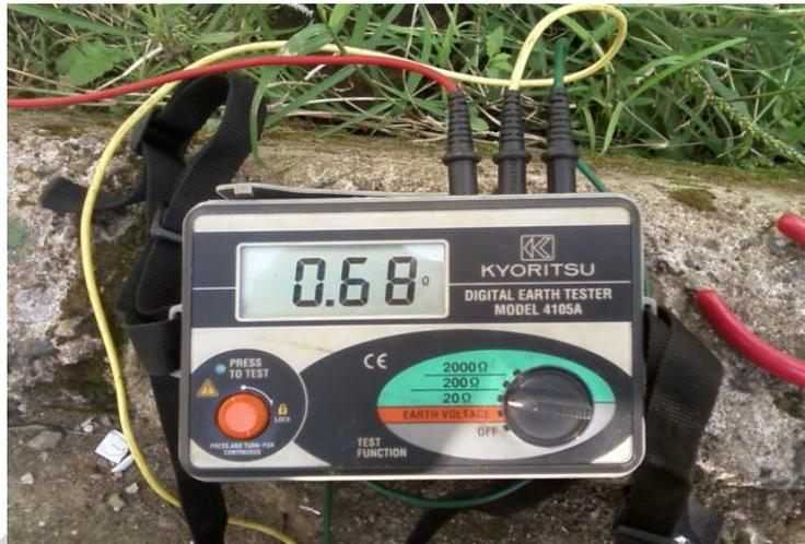
Gambar 3.24 Hasil Paralel Grounding yang terpasang dengan yang baru
