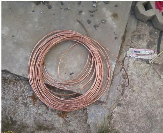
Gambar 3.8 Elektroda dengan menggunakan Kabel BC16
