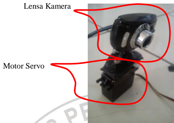
Gambar 3.6 Kamera webcam yang dipasang motor servo
