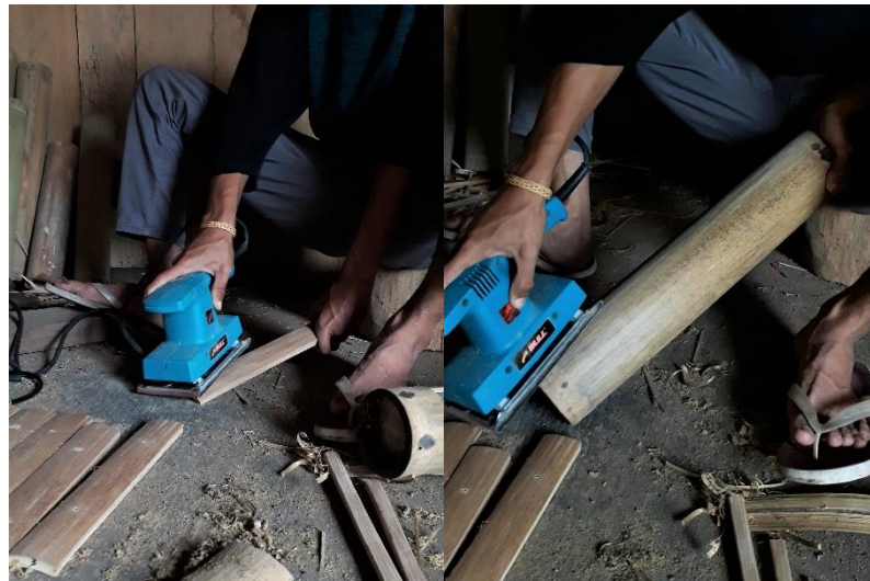
Gambar 4.13 Proses membersihkan permukaan luar dengan mesin ampelas elektrik Dokumentasi peneliti (14 Agustus 2020)
