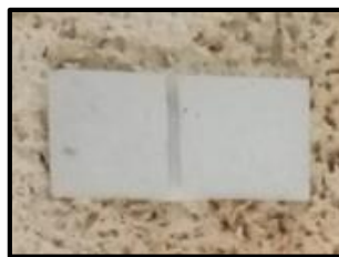
Gambar 3. 10 Substrat yang telah dilapisi pasta perak dan telah dibakar selama 10 menit dengan suhu 600^{\circ}\text{C}
