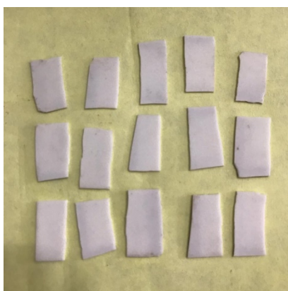
Gambar 3. 9 Pelapisan Pasta Perak pada Substrat Alumina
