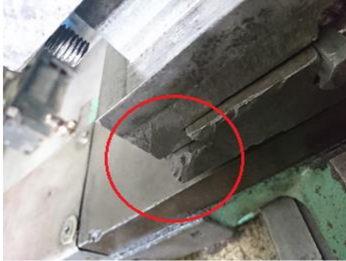
Gambar 1.1 Kerusakan pada Tool Post Mesin Bubut Kiangsi
