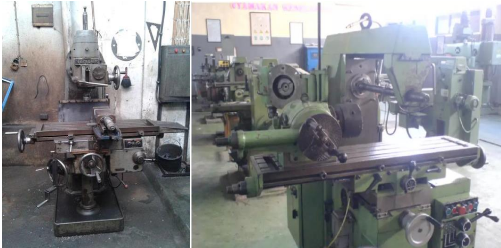
Gambar 3. 10 Mesin Frais Vertikal (kiri) dan Mesin Frais Horizontal (kanan)
