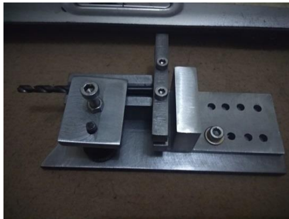
Gambar 3. 11 Fixture yang Sudah Dirakit
