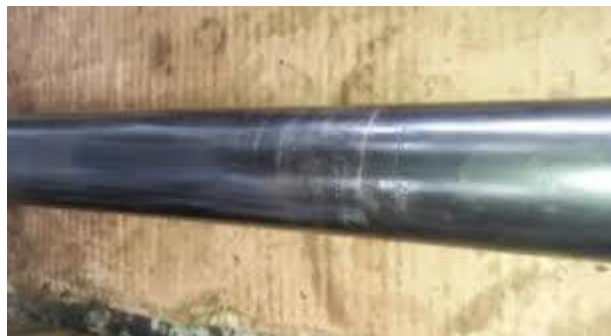
Gambar 3.13 Scratches pada Piston Rod (Sumber : eprints.ums.ac.id )
