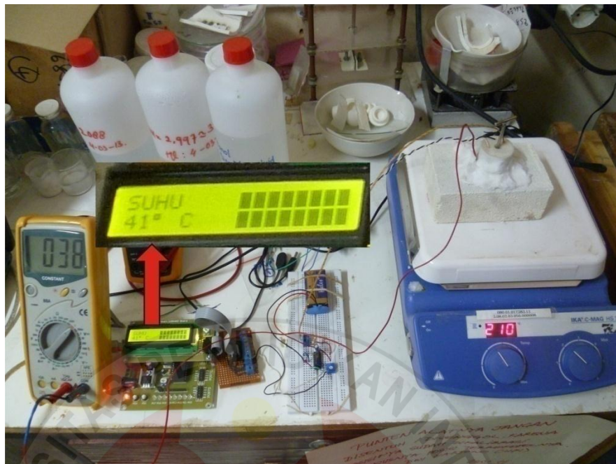
Gambar 3.1 Proses karakterisasi rangkaian penguat sinyal.
