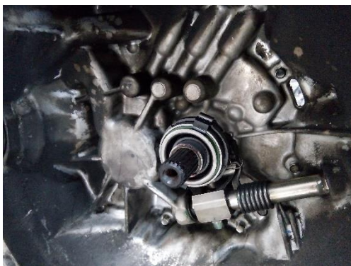
Transaxle yang sudah dibersihkan.
