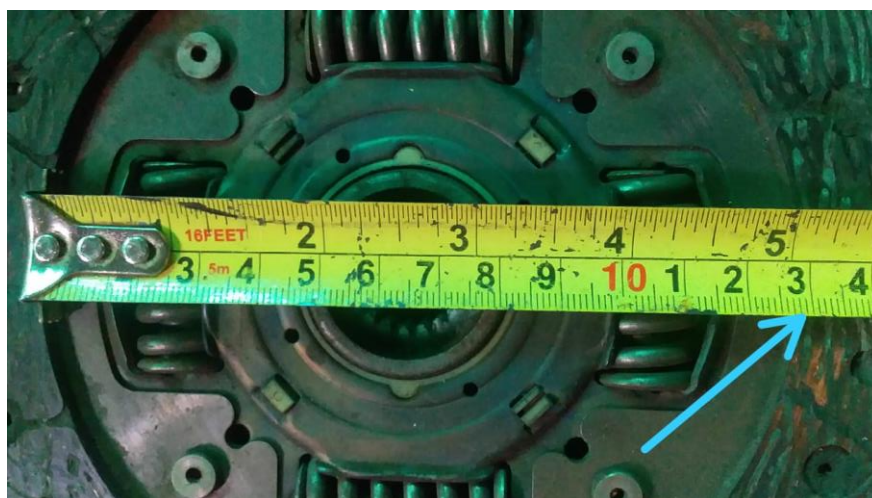
Pengukuran Diameter Dalam Disc Clutch .
