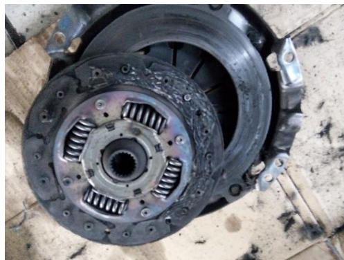
Clutch disc dan clutch cover rusak.
