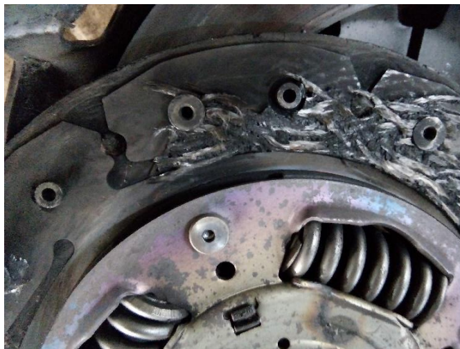
Gambar 3. 19. Lapisan Disc Clutch yang Rusak.
