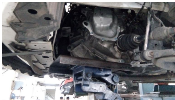
Gambar 3. 27. Pemasangan Transaxle Menggunakan Dongkrak.
