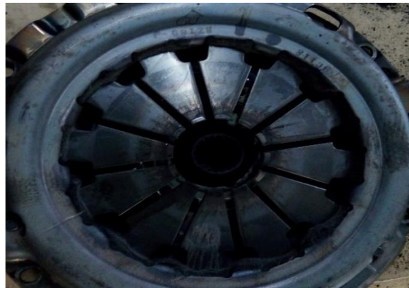
Gambar 3. 21. Keausan pada Pegas Diagfragma .
