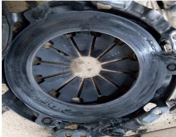
Gambar 3. 20. Permukaan Pressure Plate yang Rusak.
