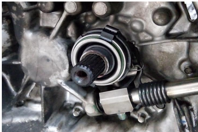
Gambar 3. 26. Pemasangan Release Bearing .
